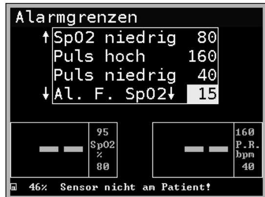
Abb. 37: Auswählen der Alarmfilterdauer
