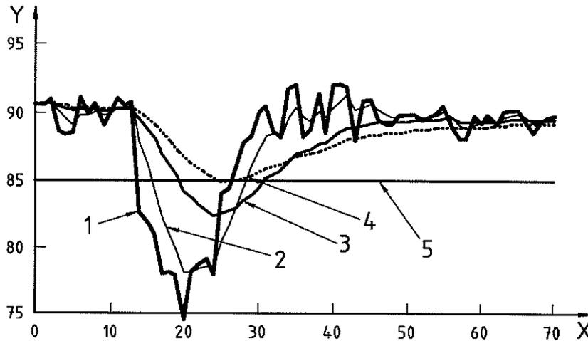
Die Abbildung stellt einen schnelleren Entsättigungsverlauf (Kurve 1) und ein realistisches, verrauschtes Sättigungssignal dar. Kurven 3 und 4 (normale bis langsame Mittelwertbildung, entsprechend 8 – 16 Sekunden) bewerten die Tiefe des Abfalls der Sättigung zu gering. Eine schnellere Mittelwertbildung (2-4 Sekunden, 4-6 Sekunden) kann die Sättigungsalarmgrenze früher unterschreiten, während die langsameren Mittelwertbildungen u.U. keine Alarmbedingung auslöst.
