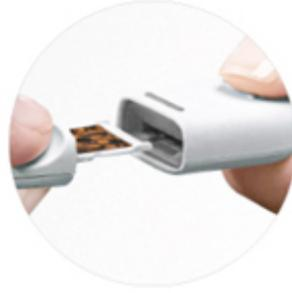
Abb. 17: RD SET Sensoranschluss
