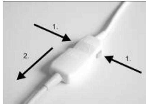
Abb. 18: LNOP Sensorkupplung
