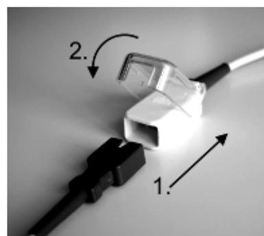
Abb. 16: LNCSSensoranschluss
