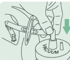
3. Setzen Sie den grauen Winkeladapter des Verbindungsschlauchs auf den Anschluss in der Mitte des Sekretbehälter deckels (oberhalb der Überlaufsicherung).
