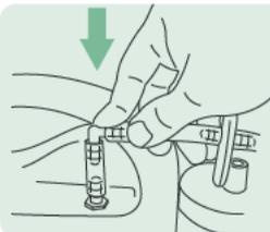
2. Stecken Sie den Verbindungsschlauch mit dem blauen Winkel zur Geräteseite auf. Achten Sie darauf, dass die Seite des Bakterienfilters mit der Beschriftung „IN“ zum Behälter (in Richtung Patient) zeigt!
