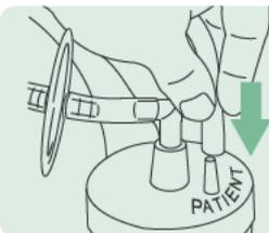
4. Setzen Sie den Absaugschlauch auf den zweiten Anschluss (Patientenanschluss). Achten Sie dabei auf einen ausreichend festen Sitz des Schlauchs.
